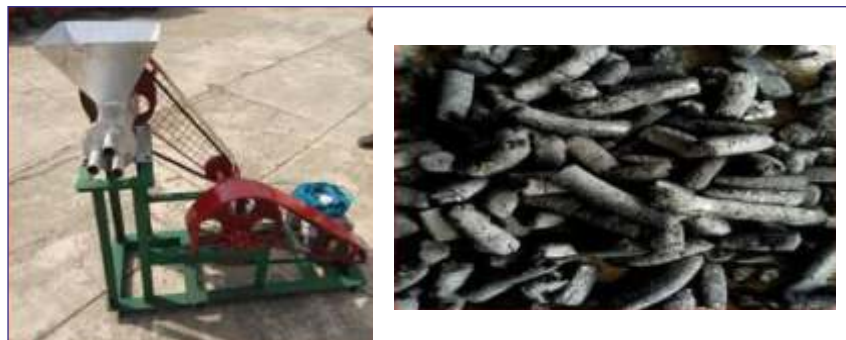
चित्र 6: मोटर चालित टिकली बनाने की मशीन
