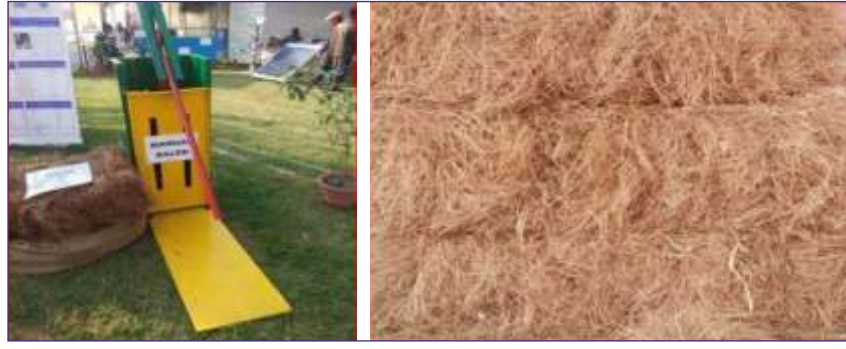
चित्र 4: हस्त चालित गठ्टर बनाने की मशीन
