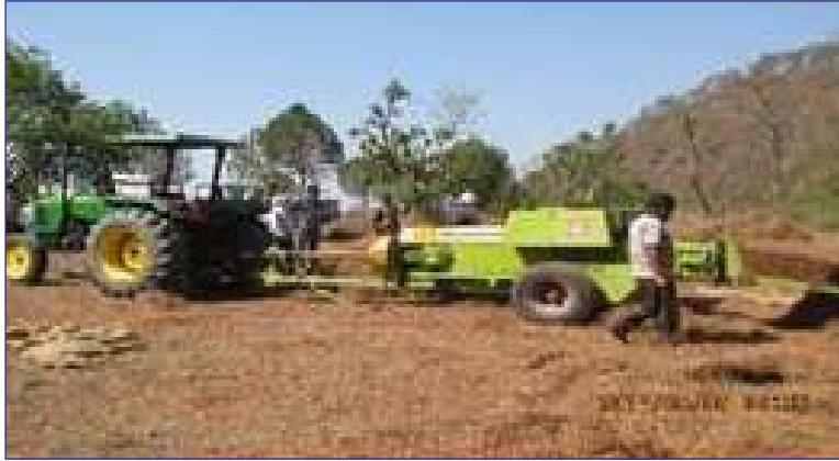
चित्र 3: ट्रैक्टर चालित चीड़ की पत्तियों के गठुर बनाने की मशीन
