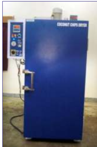
चित्र 4: विद्युत चालित नारियल चिप्स को सुखाने की मशीन
