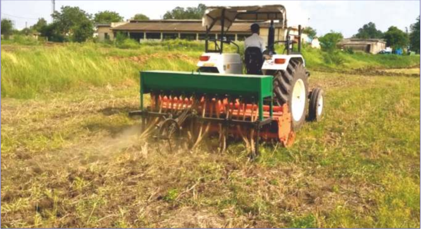
चित्र 1: ट्रैक्टर चलित स्ट्रिप ट्रिल-ड्रिल से मक्का की बुवाई
