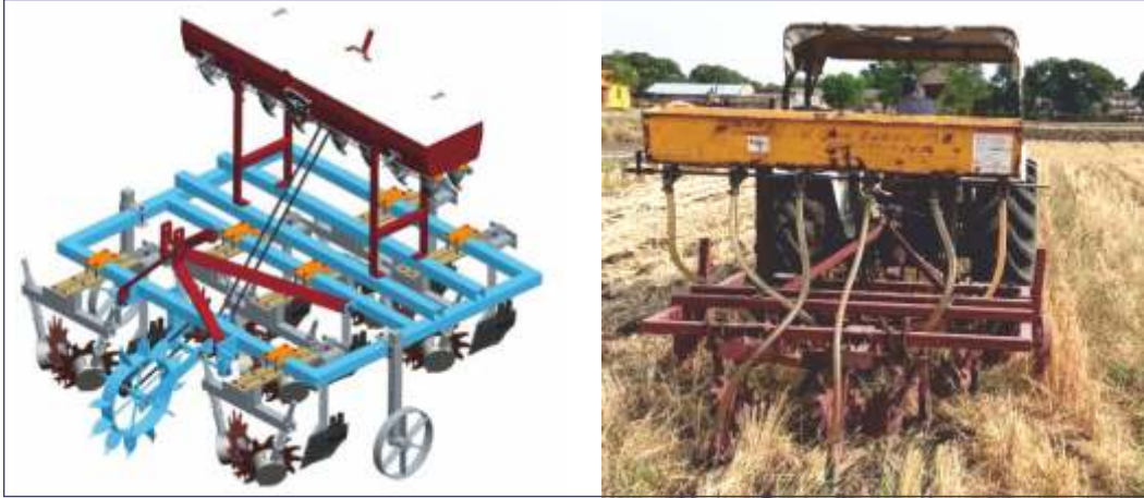
चित्र 1: भूसा अवशेष की स्थिति में विकसित मशीन के काम करने का प्रदर्शन
