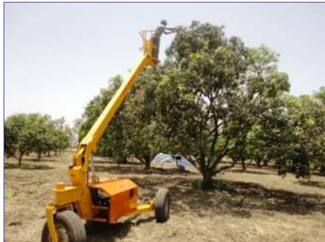
चित्र 2: स्व-चालित बहु-उपयोगी बाग प्रबंधन प्रणाली
