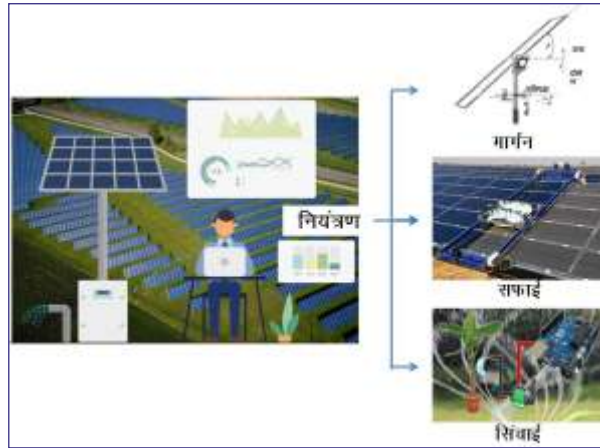
चित्र 4: सौर ऊर्जा चालित सिंचाई में आई.ओ.टी. आधारित नियंत्रण
