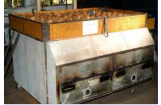
चित्र 1: नारियल के कठोर खोल की ऊष्मा से चालित नारियल गरी शुष्कक यंत्र
